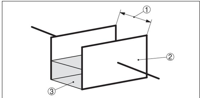
Abb. 3: Funktionsprinzip - Plattenkondensator
