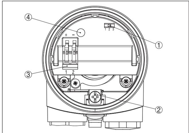
Abb. 15: Elektronikeinsatz - Zweileiterausgang
