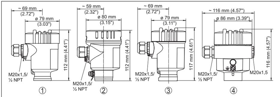
Abb. 22: Gehäuseausführungen in Schutzart IP66/IP67 und IP66/IP68 (0,2 bar)
