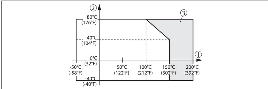
Abb. 21: Umgebungstemperatur - Prozesstemperatur
