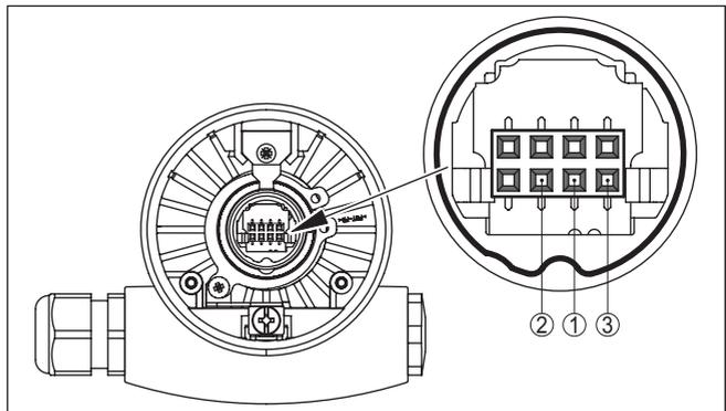
Abb. 17: Widerstand innerhalb der Messsonde prüfen
