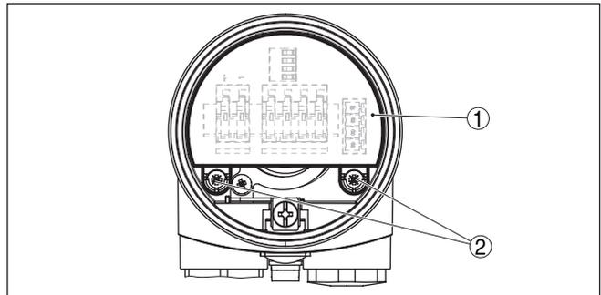
Abb. 18: Halteschrauben lösen
