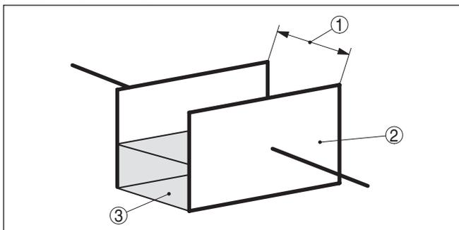
Fig. 3: Princípio de funcionamento - Condensador de placas paralelas
