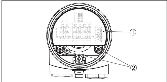
Fig. 18: Soltar os parafusos de fixação
