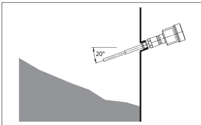
Fig. 6: Montagem horizontal
