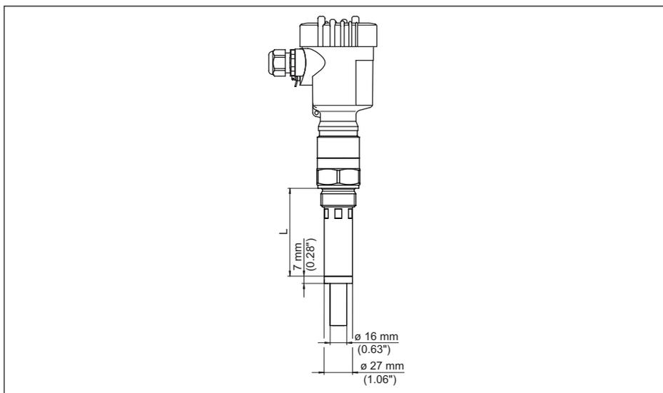
Fig. 26: VEGACAP 62, tubo de blindagem, por exemplo, contra forte condensação
