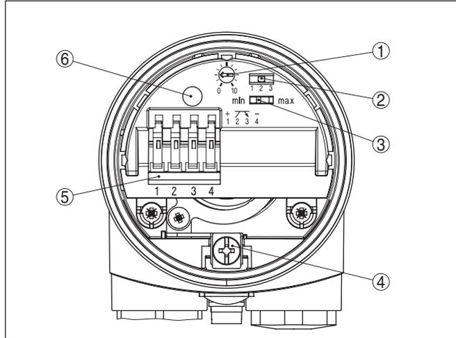
Abb. 11: Elektronik- und Anschlussraum
