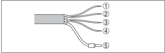
Abb. 15: Aderbelegung Anschlusskabel. Die Nummern der Adern entsprechen den Anschlussklemmen des Gerätes.
