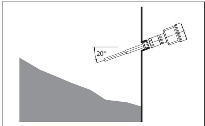
Abb. 6: Waagerechte Montage
