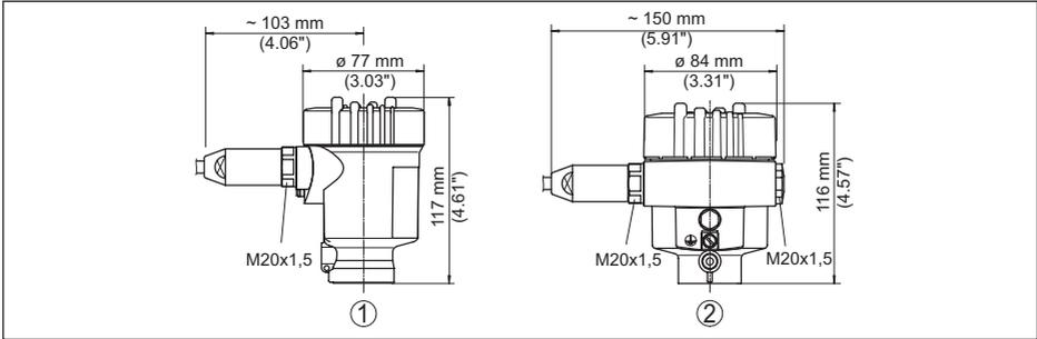
Abb. 23: Gehäuseausführungen in Schutzart IP66/IP68 (1 bar)
