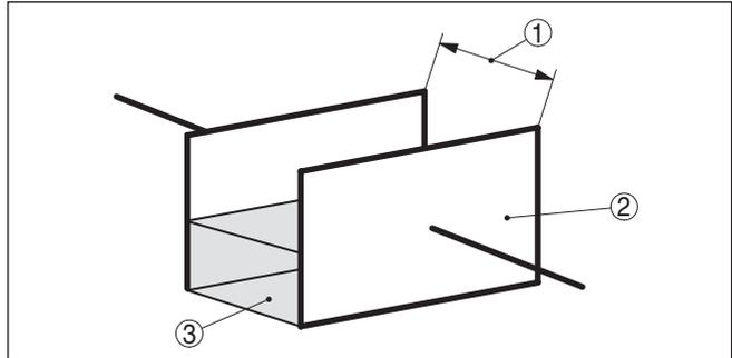
Abb. 3: Funktionsprinzip - Plattenkondensator
