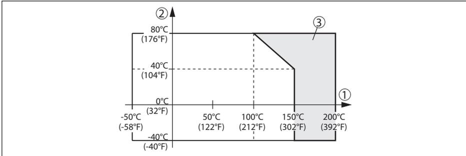
Abb. 21: Umgebungstemperatur - Prozesstemperatur
