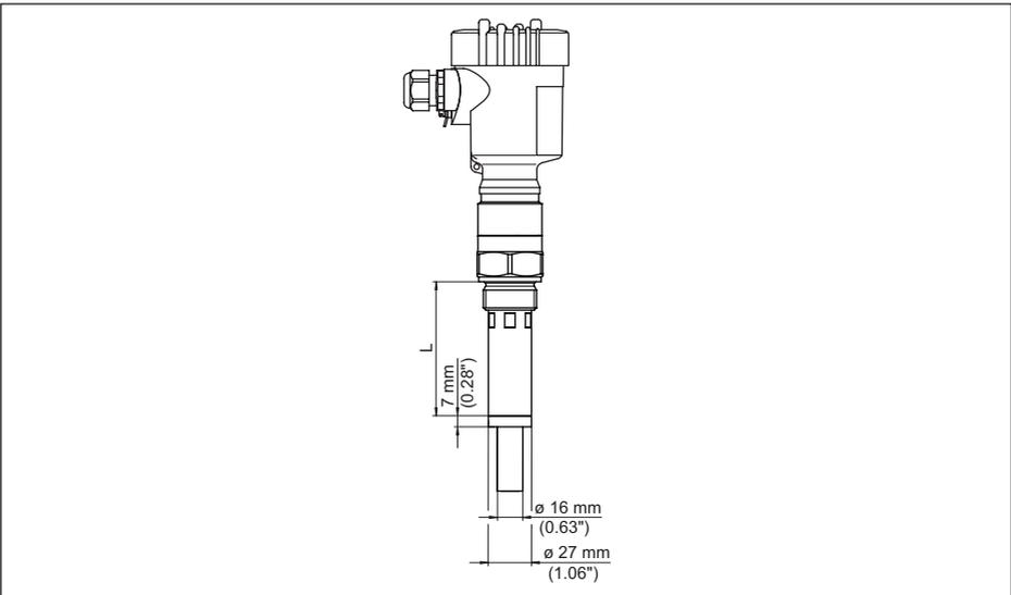
Abb. 26: VEGACAP 62, Abschirmrohr z. B. gegen starke Kondensatbildung
