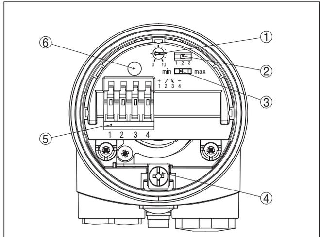
Abb. 16: Elektronikeinsatz - Transistorausgang
