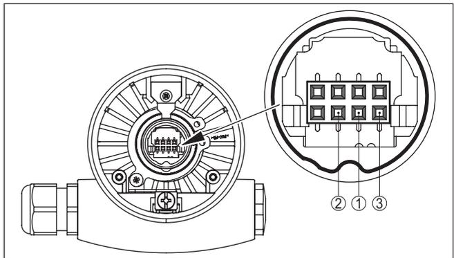
Abb. 17: Widerstand innerhalb der Messsonde prüfen
