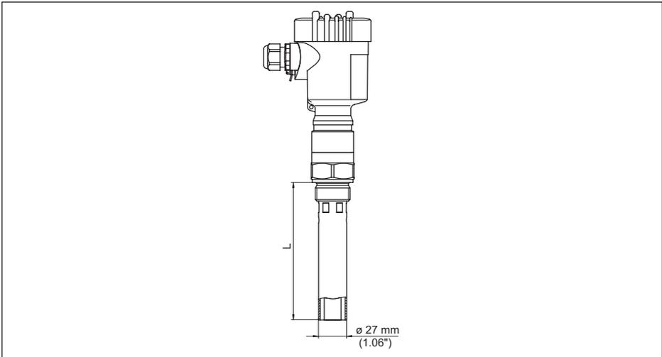
Abb. 27: VEGACAP 62, Hüllrohr z. B. bei kleiner Dielektrizitätszahl oder zur Linearisierung
