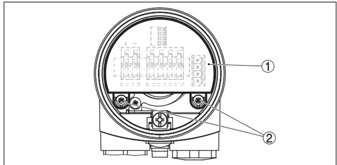
Abb. 18: Halteschrauben lösen
