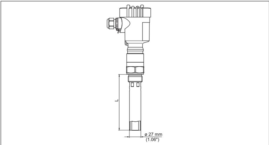
Fig. 23: VEGACAP 62, tubo concéntrico p. Ej. constante dieléctrica pequeña o para linealización
