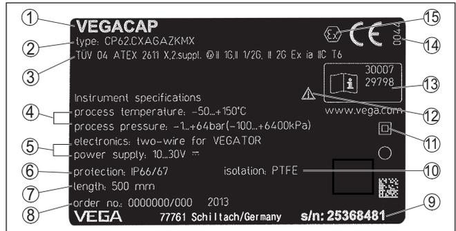
Fig. 2: Estructura de la placa de tipos (ejemplo)
