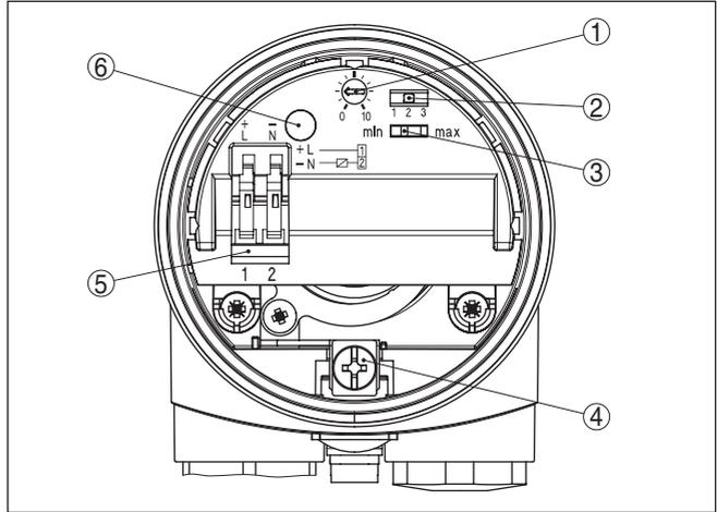
Fig. 11: Compartimento de la electrónica y de conexiones
