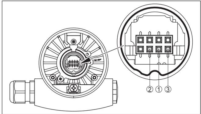
Fig. 14: Comprobar la resistencia dentro de la sonda de medición
