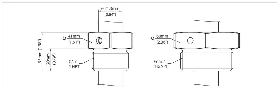
Figura 2: Dispositivo di blocco a vite ARV-SG63.1 in assenza di pressione per VEGASWING 63
