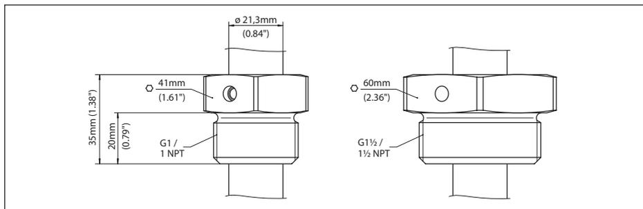
Fig. 2: Raccord d'arrêt ARV-SG63.1 sans pression pour VEGASWING 63
