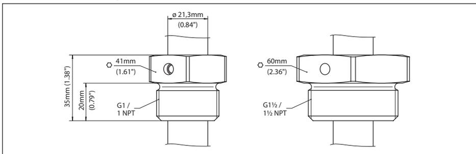
Abb. 2: Arretierverschraubung ARV-SG63.1 drucklos für VEGASWING 63
