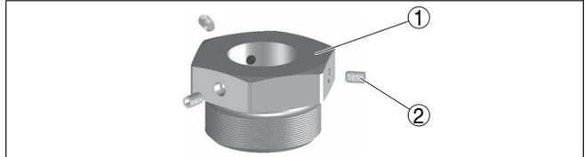
Abb. 1: Arretierverschraubung ARV-SG63.1 - drucklos
