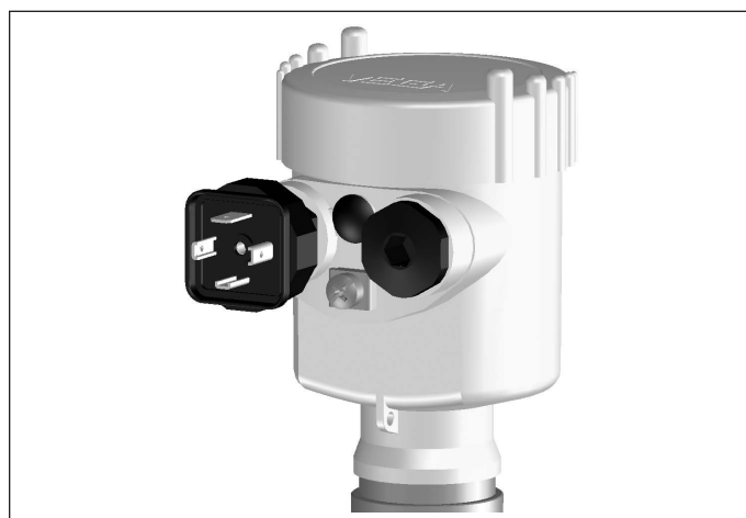
Abb. 6: Steckverbinder - z. B. VEGAVIB/VEGAWAVE Serie 60 mit ISO 4400-Stecker
