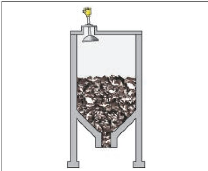
Fig. 18: Mesure de niveau dans un silo de klinker avec le VEGAPULS 68
