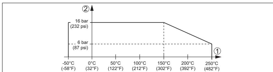
Fig. 14: Pressão do processo - temperatura do processo
