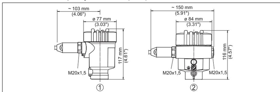
Fig. 18: Modelos da caixa com proteção IP66/IP68 (1 bar)
