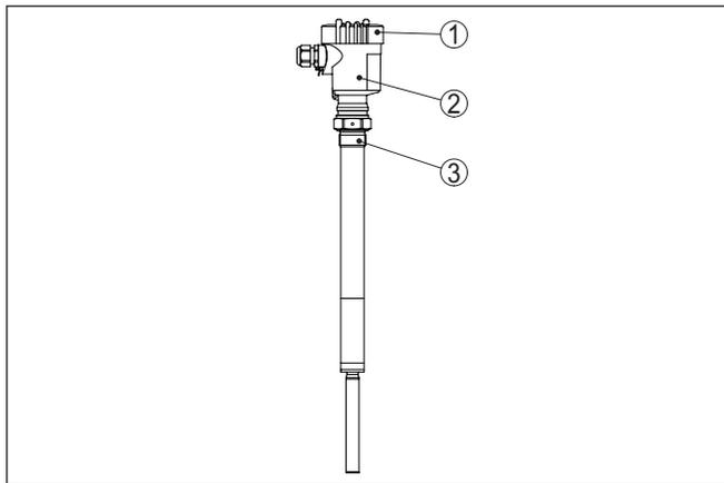
Fig. 1: VEGAVIB 63 com caixa de plástico
