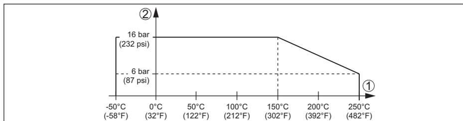
Fig. 15: Pressão do processo - temperatura do processo
