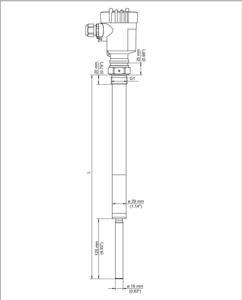
Figura 15: VEGAVIB 63 - Esecuzione filettata G1 (DIN ISO 228/1)
