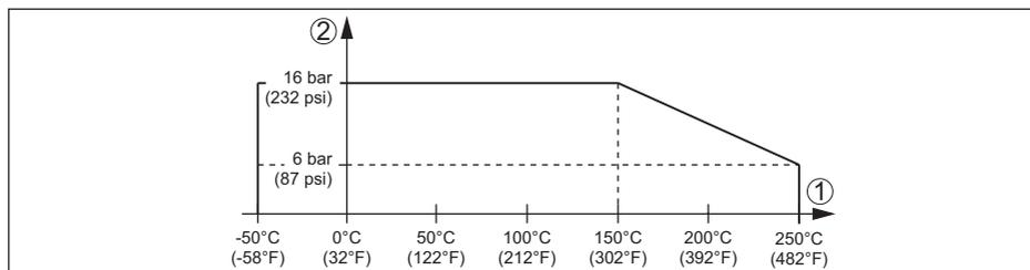
Figura 12: Pressione di processo - Temperatura di processo
