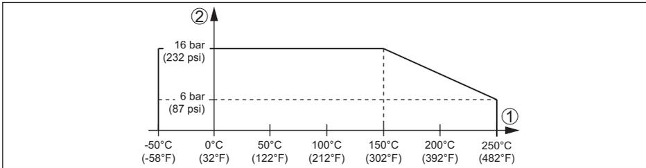
Abb. 12: Prozessdruck - Prozesstemperatur
