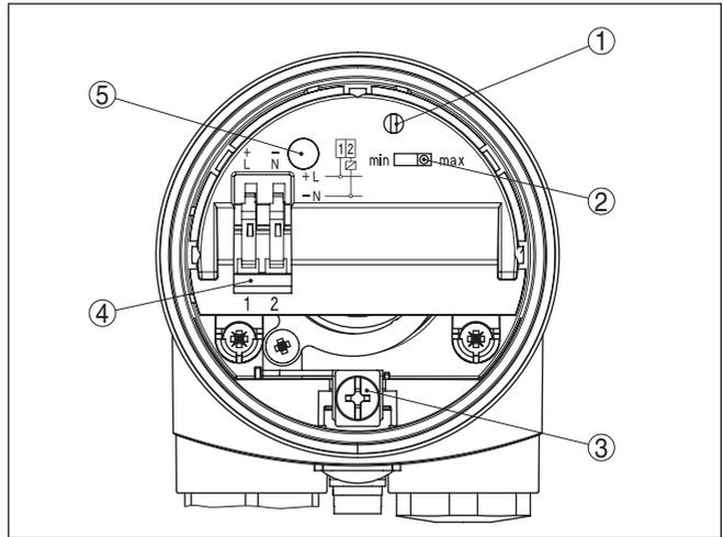
Abb. 10: Elektronik- und Anschlussraum - kontaktloser Schalter
