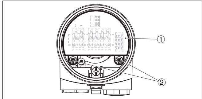
Abb. 11: Halteschrauben lösen
