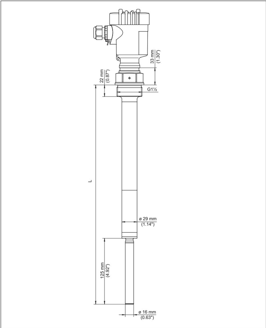
Abb. 16: VEGAVIB 63, Gewindeausführung G1½ (DIN ISO 228/1)
