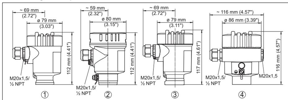
Fig. 14: Versiones de carcasa en grado de protección IP66/IP67 e IP66/IP68; 0,2 bar
