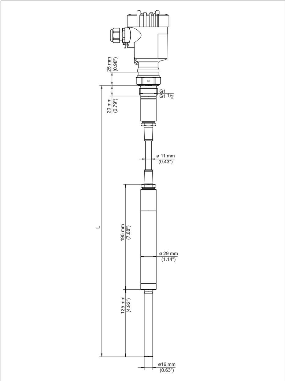
Fig. 16: VEGAVIB 62 con cable portador de PUR
