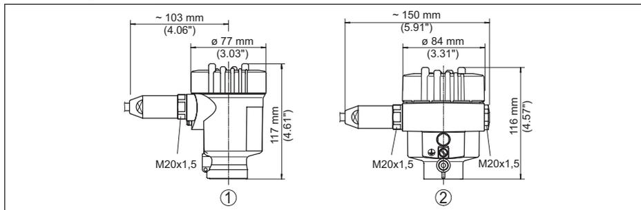
Fig. 15: Variante de carcasa en grado de protección IP66/IP68 (1 bar)
