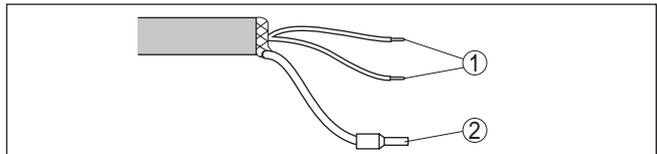
Fig. 10: Ocupación de conductores del cable de conexión
