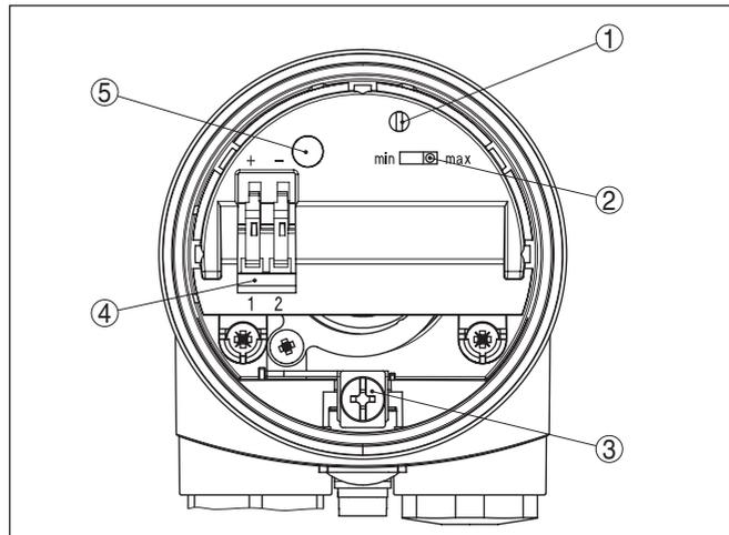
Fig. 11: Compartiment électronique et de raccordement - sortie bifilaire
