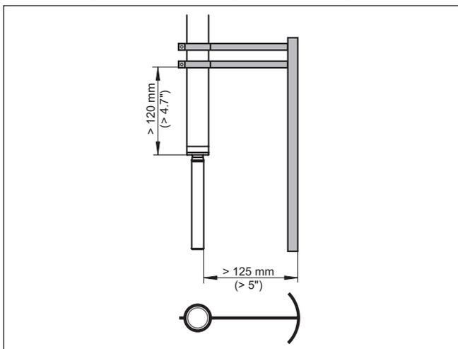
Fig. 6: Tôle de chicane pour protection contre les détériorations
