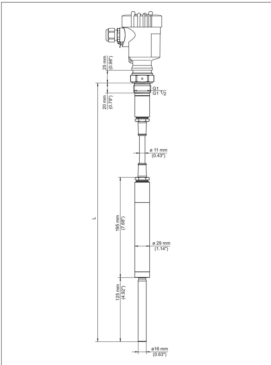
Fig. 16: VEGAVIB 62 avec câble porteur PUR
