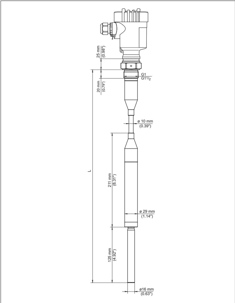
Fig. 17: VEGAVIB 62 avec câble porteur FEP
