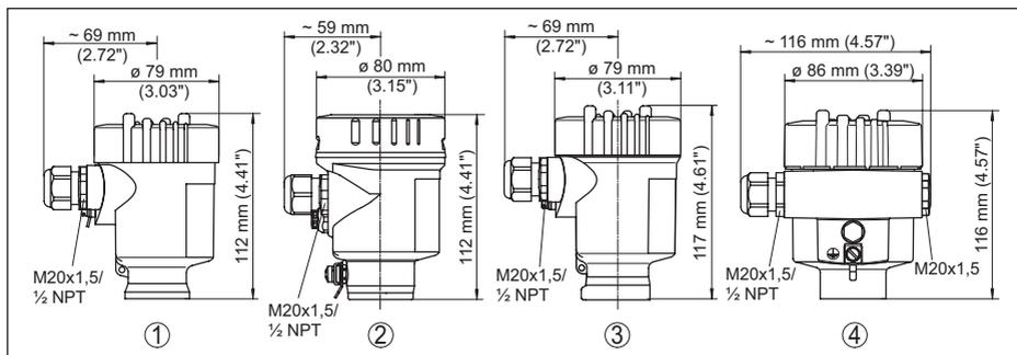
Fig. 14: Versions de boîtier en protection IP66/IP67 et IP66/IP68; 0,2 bars
