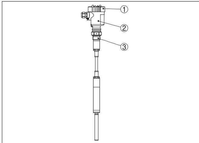
Fig. 1: VEGAVIB 62 avec boîtier en plastique
