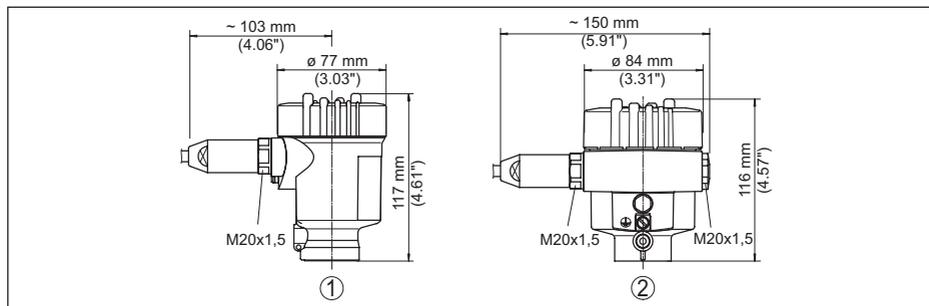
Fig. 15: Variantes de boîtier en protection IP66/IP68 (1 bar)
