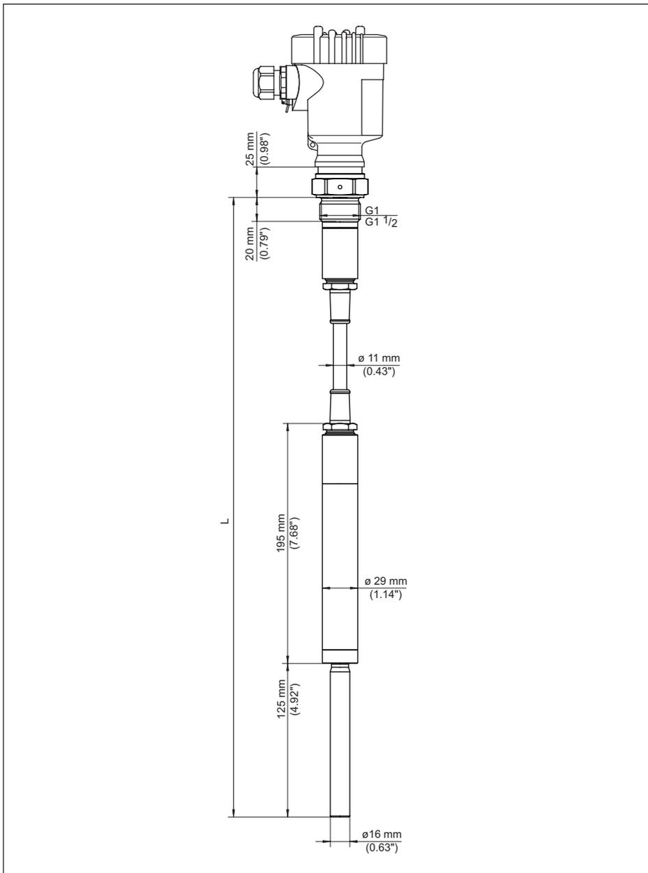
Fig. 17: VEGAVIB 62 con cable portador de PUR
