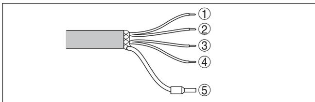
Fig. 12: Ocupación de cables en el cable de conexión. Los números de los conductores concuerdan con los bornes del equipo.
