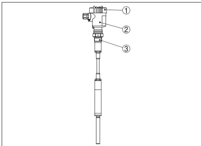
Fig. 1: VEGAVIB 62 com caixa de plástico
