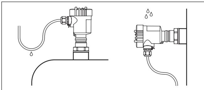
Fig. 2: Medidas para evitar a entrada de umidade
