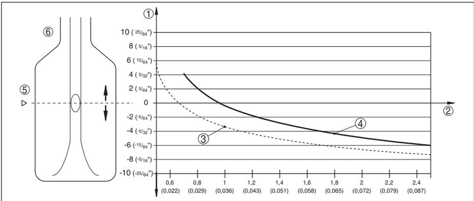
Abb. 12: Einfluss der Füllgutdichte auf den Schaltpunkt
