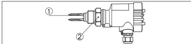
Abb. 3: Waagerechte Montage
