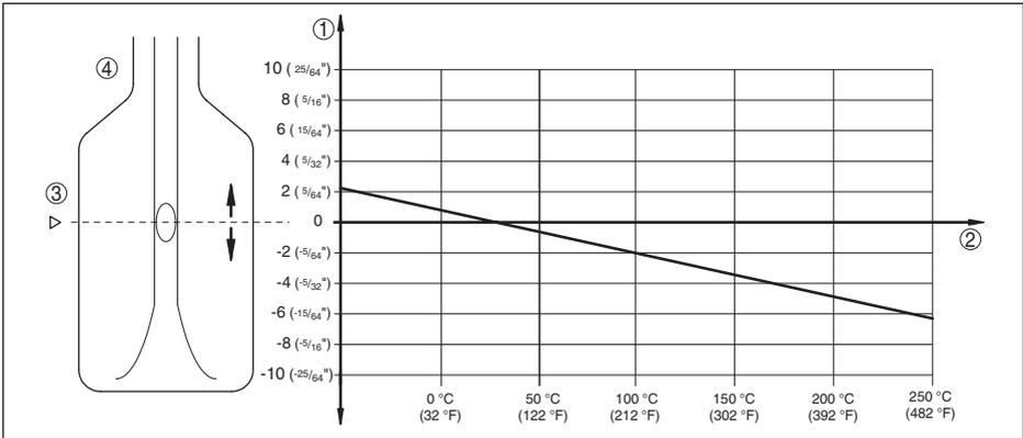
Abb. 11: Einfluss der Prozesstemperatur auf den Schaltpunkt
