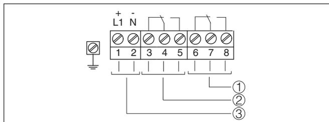
Abb. 9: Anschlussplan Einkammergehäuse
