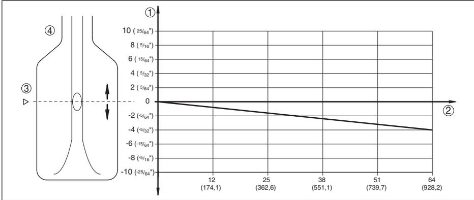
Abb. 13: Einfluss des Prozessdruckes auf den Schaltpunkt
