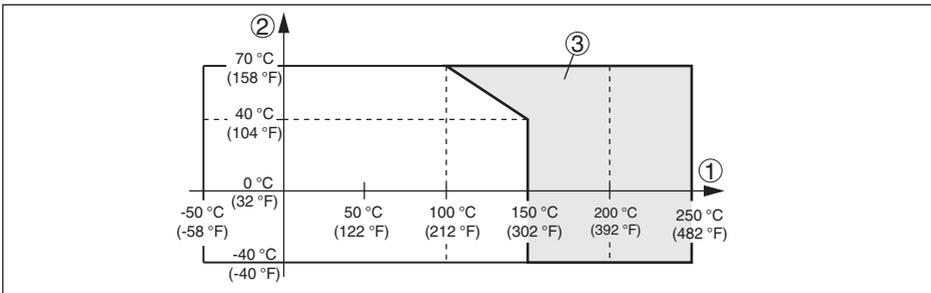
Abb. 14: Umgebungstemperatur - Prozesstemperatur
