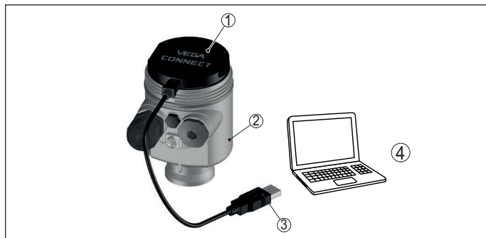
Fig. 16: Conexión del PC vía VEGACONNECT y USB
