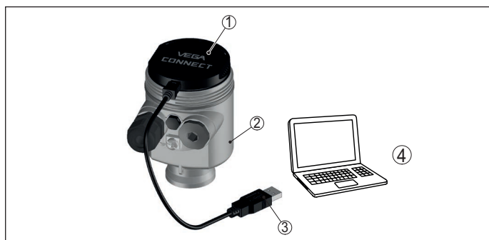
Fig. 16: Aansluiting van de PC via VEGACONNECT en USB
