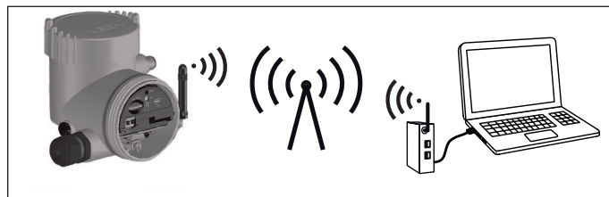
Fig. 22: Transmission des valeurs mesurées et du paramétrage à distance du capteur via le réseau téléphonique mobile
