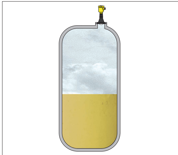
Figura 26: Misura di livello in un serbatoio contenente acidi con VEGAPULS 61
