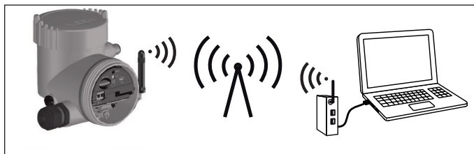
Fig. 51: Transmission des valeurs mesurées et du paramétrage à distance du capteur via le réseau téléphonique mobile
