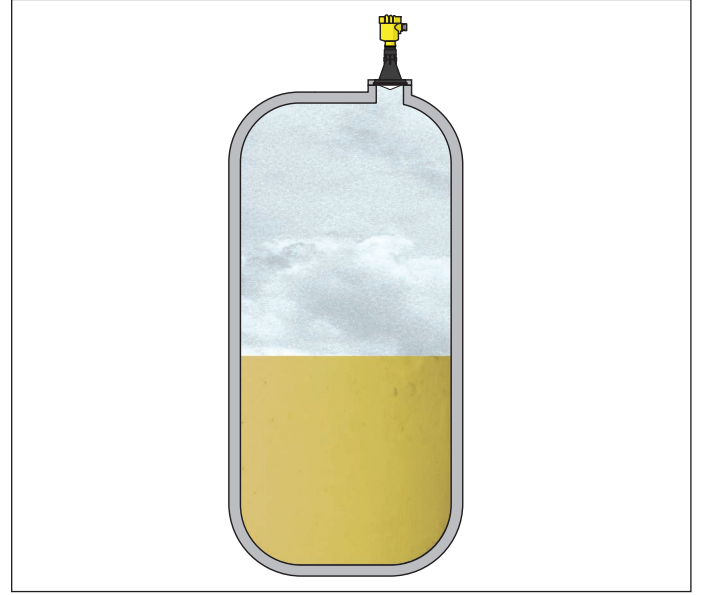
Res. 26: VEGAPULS 61 ile bir asit tankında seviye ölçümü
