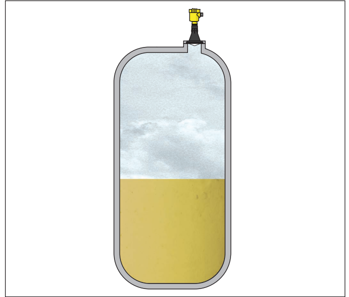
Abb. 26: Füllstandmessung in einem Säuretank mit VEGAPULS 61
