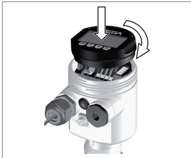
Figura 27: Inserimento del tastierino di taratura con display nella custodia a camera
