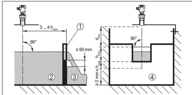
Fig. 16: Mesure de débit avec déversoir rectangulaire :  $d_{min}$  = distance de blochage du capteur (voir chapitre "Caractéristiques techniques") ;  $h_{max}$  = remplissage max. du déversoir rectangulaire
