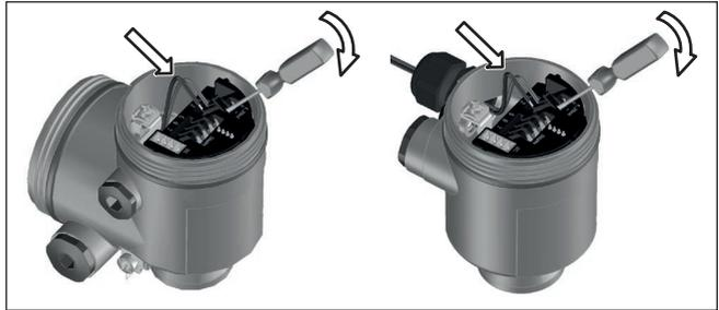
Fig. 18: Étapes de raccordement 6 et 7
