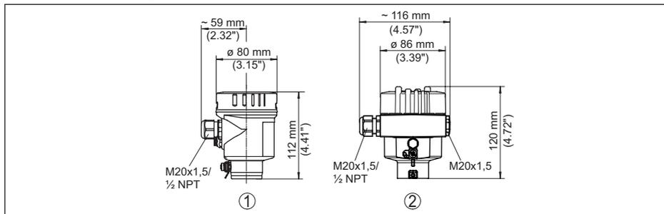
Fig. 40: Variantes de boîtier en protection IP66/IP68 (0,2 bar), (avec un module de réglage et d'affichage intégré, la hauteur du boîtier augmente de 18 mm/0.71 in)
