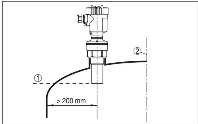
Fig. 6: Montage sur cuve à toit bombé
