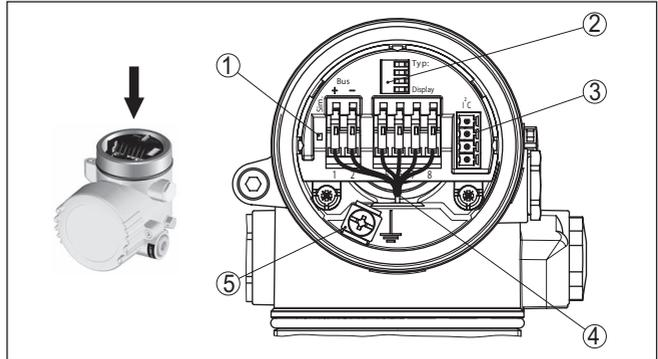
Fig. 23: Compartiment électronique - boîtier à deux chambres
