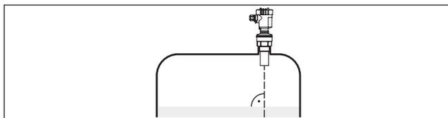
Fig. 10: Orientation du capteur dans les liquides
