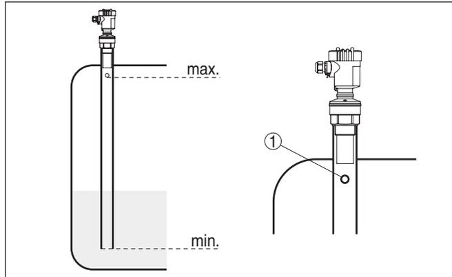
Fig. 15: Tube de mesure dans une cuve
