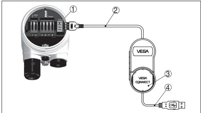
Fig. 31: Raccordement via l'adaptateur d'interface VEGACONNECT externe
