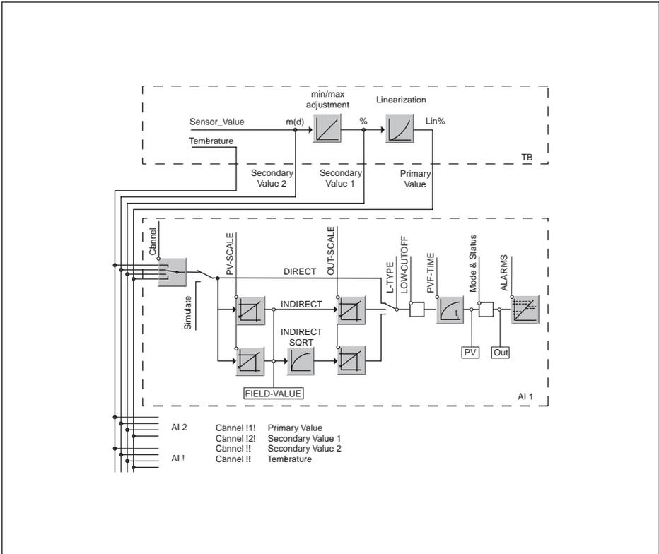
Fig. 35: Traitement des valeurs de mesure VEGASON 62
