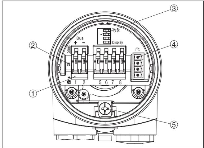
Abb. 20: Elektronik- und Anschlussraum - Einkammergehäuse
