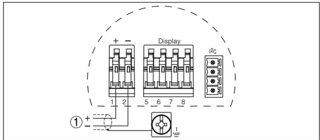
Abb. 21: Anschlussplan - Einkammergehäuse
