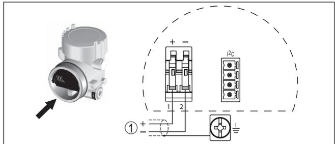
Abb. 25: Anschlussplan - Zweikammergehäuse
