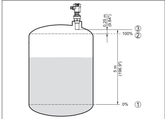
Abb. 29: Parametrierbeispiel Min./Max.-Abgleich
