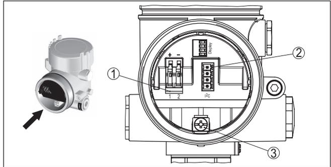
Abb. 24: Anschlussraum - Zweikammergehäuse
