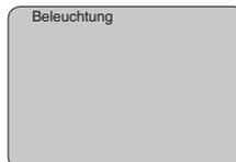
In der Werkseinstellung ist die Beleuchtung ausgeschaltet.
