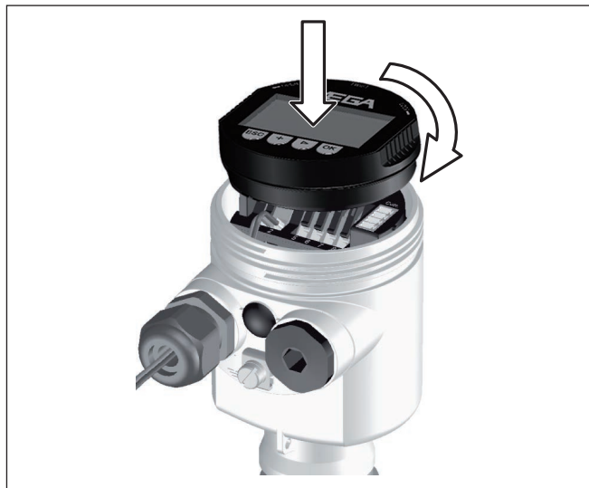
Fig. 25: Colocar o módulo de visualização e configuração na caixa de uma câmara
