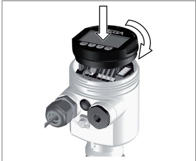
Fig. 25: Poner el módulo de visualización y configuración en la carcasa de una cámara
