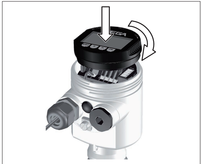
Fig. 25: Display- en bedieningsmodule in de eenkamerbehuizing plaatsen
