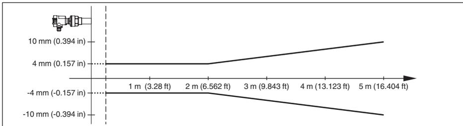
Fig. 30: Diferença na medição VEGASON 61
