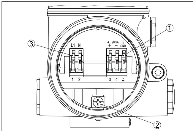
Fig. 21: Compartimento de conexão - Caixa de duas câmaras
