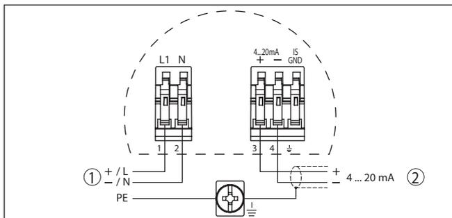
Fig. 22: Esquema de ligações - Caixa de duas câmaras
