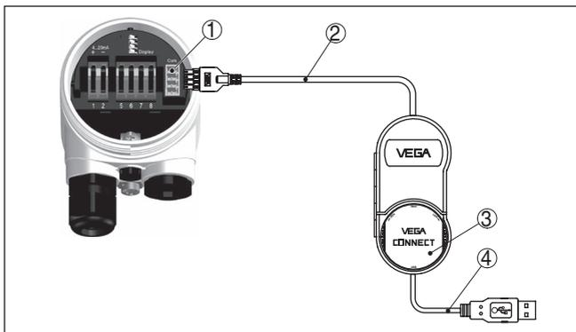
Fig. 27: Conexão via adaptador de interface VEGACONNECT externo
