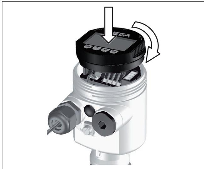
Figura 27: Inserimento del tastierino di taratura con display nella custodia a una camera
