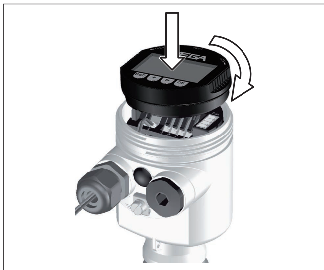
Fig. 29: Insérer le module de réglage et d'affichage dans le boîtier à une chambre
