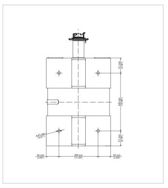
Soporte de montaje con perforaciones de montaje
