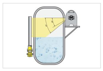
Ajuste - contenedor de protección de fuente radiactiva Ángulo de apertura 30° y 45°
