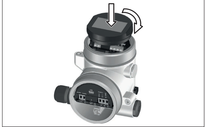
Res. 8: Gösterge ve ayar modülünün yerleştirilmesi
