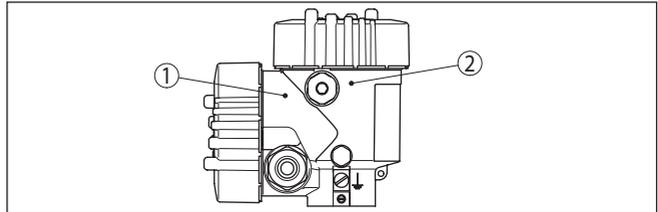
Fig. 1: Posición de la electrónica adicional dentro de la segunda cámara y de la electrónica principal dentro del compartimento de la electrónica (representación ejemplar)
