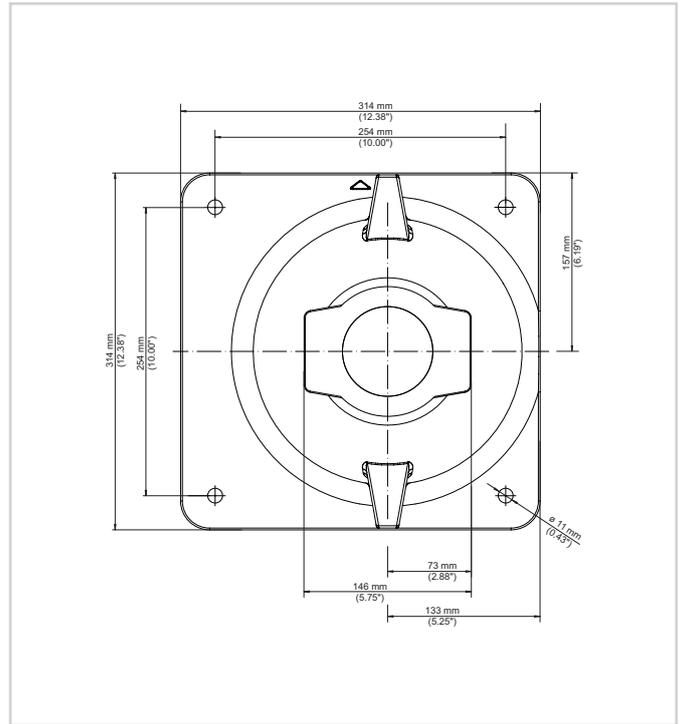
Placa base con perforaciones de montaje
