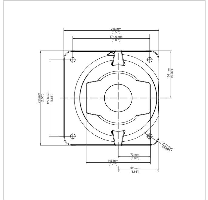
Placa base con perforaciones de montaje
