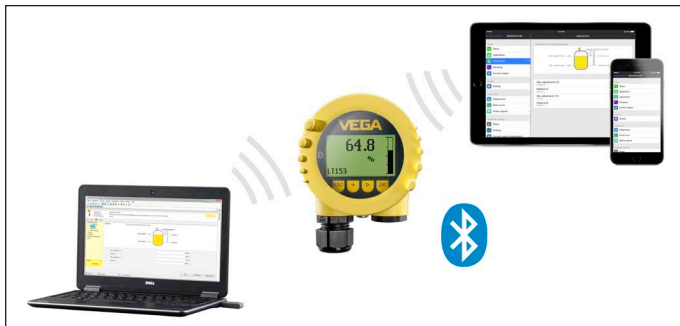
Fig. 1: Conexión inalámbrica con instrumentos de configuración estándar
