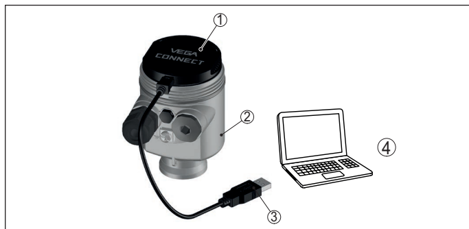
Fig. 23: Aansluiting van de PC via VEGACONNECT en USB
