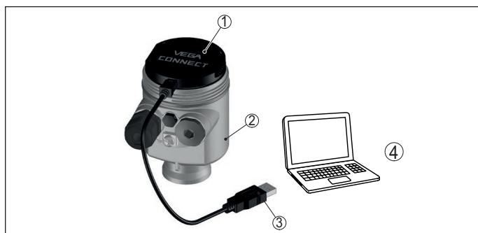
Figura 23: Collegamento del PC via VEGACONNECT e USB
