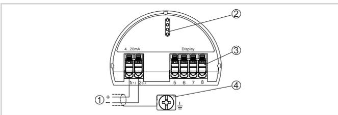
Elektronik- und Anschlussraum Einkammergehäuse (Beispiel)
