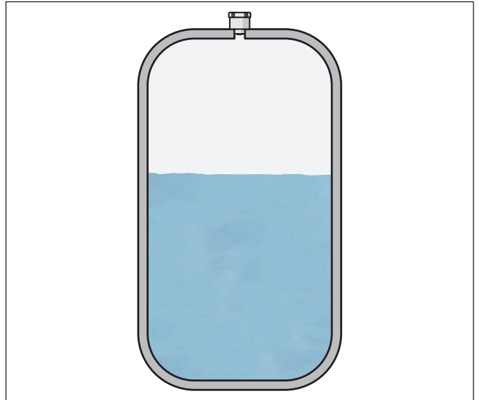
Abb. 14: Füllstandmessung mit VEGAPULS Air 41 im Flüssigkeitstank
