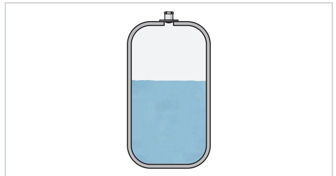
Medición de nivel en tanque de líquidos
