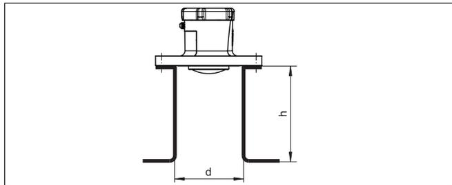
Figura 9: Montaggio su tronchetto in caso di dimensioni diverse del tronchetto
