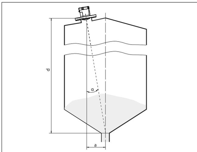
Figura 12: Presentazione di installazione dopo orientamento del VEGAPULS Air 42
