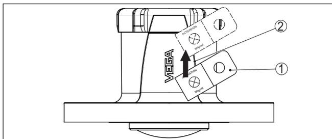
Figura 14: Attivazione del sensore tramite magnete
