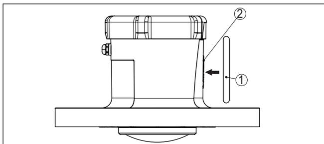
Figura 13: Attivare il sensore
