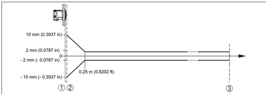
Figura 28: Scostamento di misura sotto condizioni di riferimento
