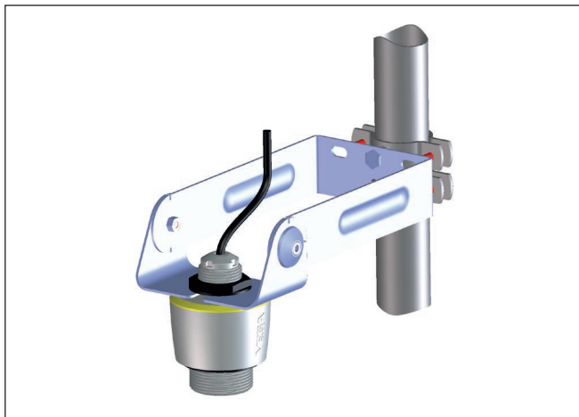
Fig. 17: arco de montagem em tubo na posição vertical por meio de braçadeiras de tubo confeccionadas pelo próprio usuário
