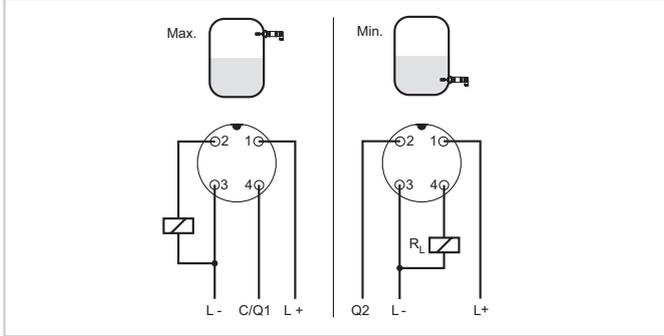
Esquema de conexión (carcasa), designación de terminales Salida IO-Link con M12 x 1-conexión enchufable
