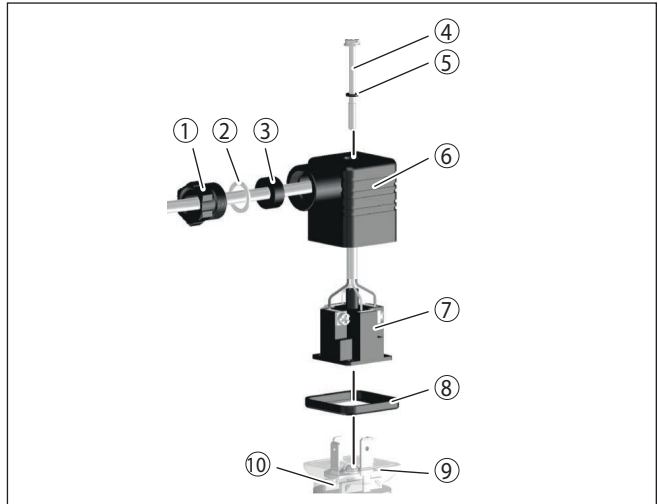
Fig. 9: Conexão conector de válvula ISO 4400
