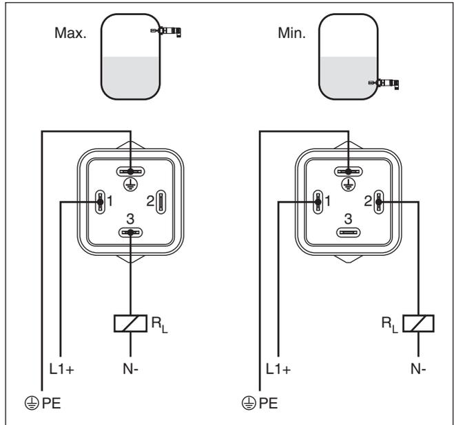
Abb. 13: Anschlussplan, kontaktloser Schalter bei Ventilstecker ISO 4400
