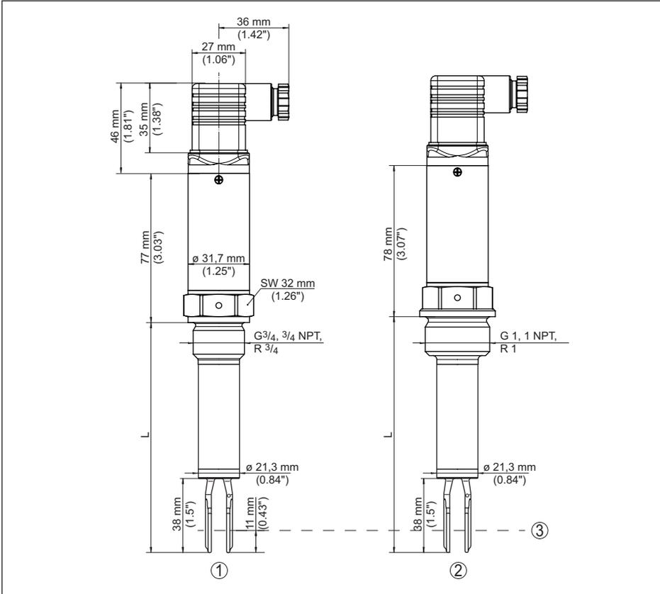
Abb. 18: VEGASWING 53, Hochtemperatursausführung, Gewindeanschlüsse
