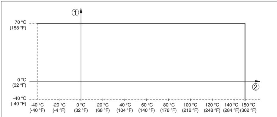
Abb. 16: Abhängigkeit Umgebungstemperatur zu Prozesstemperatur
