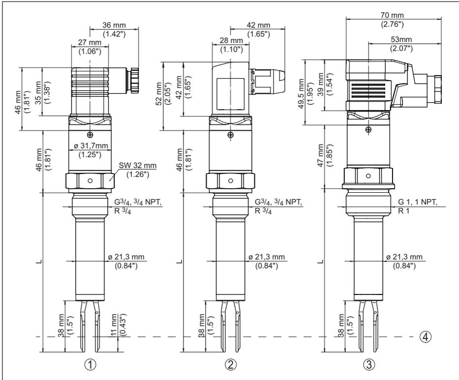
Abb. 17: VEGASWING 53, Standardausführung, Gewindeanschlüsse
