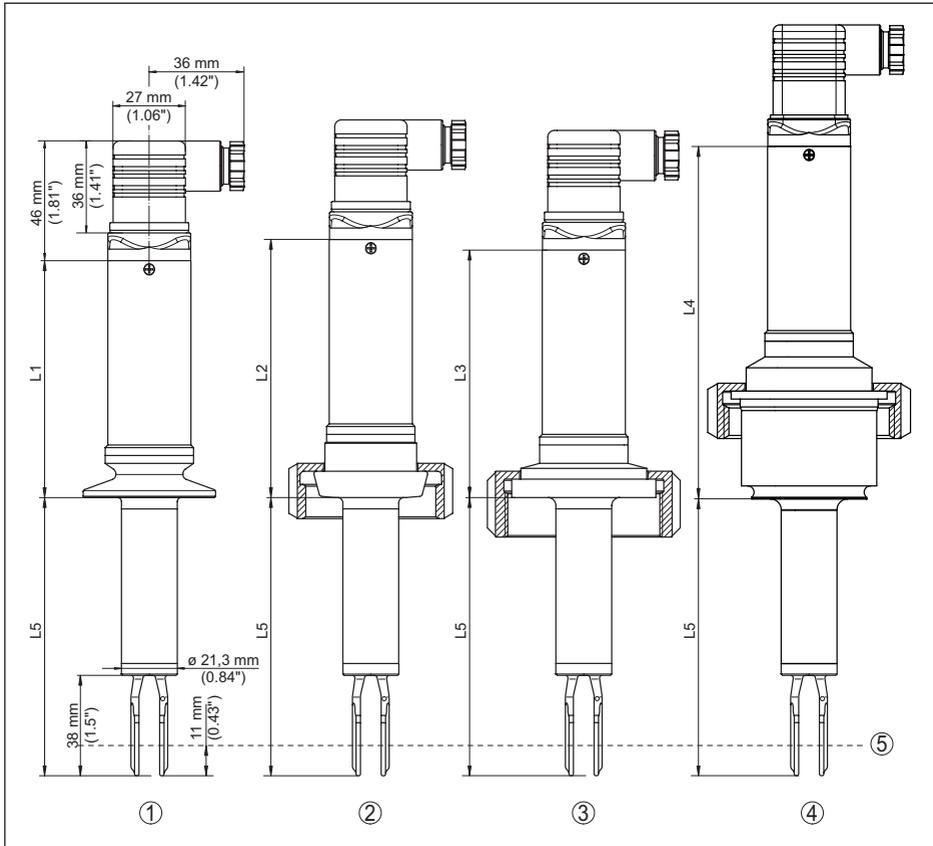
Abb. 19: VEGASWING 53, Lebensmittelausführung, Hygieneanschlüsse
